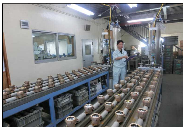
水道メーター検定の様子
