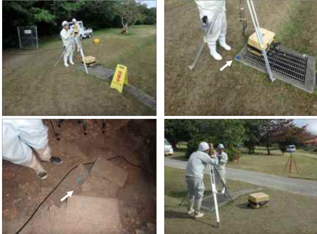
図 2-6 評定点測量およびターゲット測量風景
