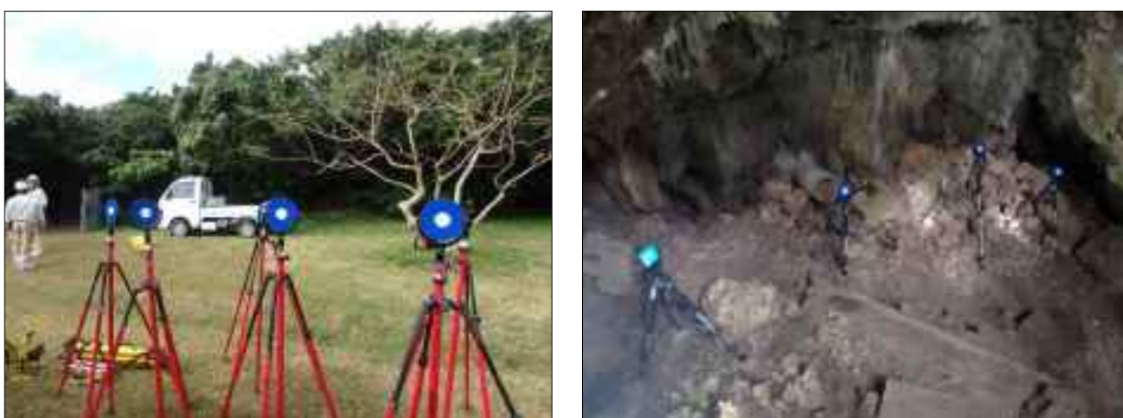
図 3-3 ターゲット（左：大型のターゲット、右：コンパクトなターゲット）
