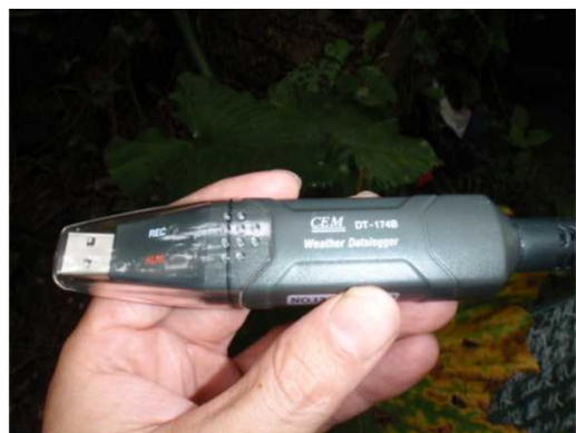
写真 I-2-71 気温・湿度・気圧ロガー
