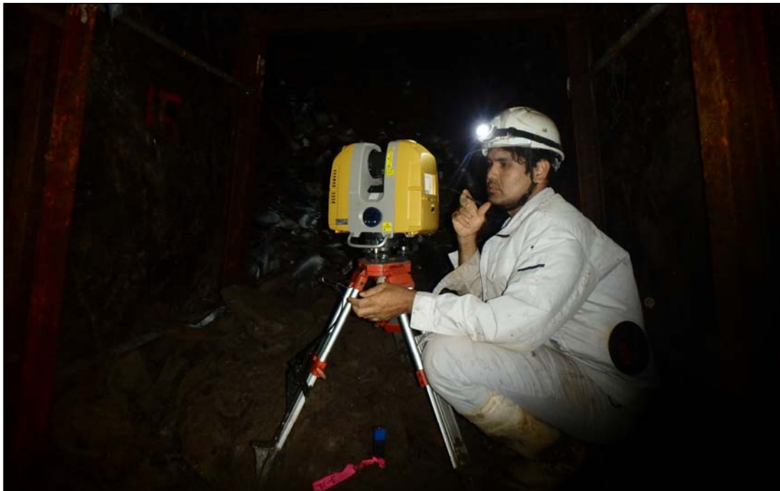
坑道内レーザー測量にて使用したレーザー測量機器
