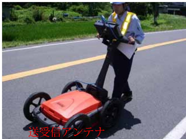
参考図 地中レーダー探査による空洞・緩み調査 (参考事例)
