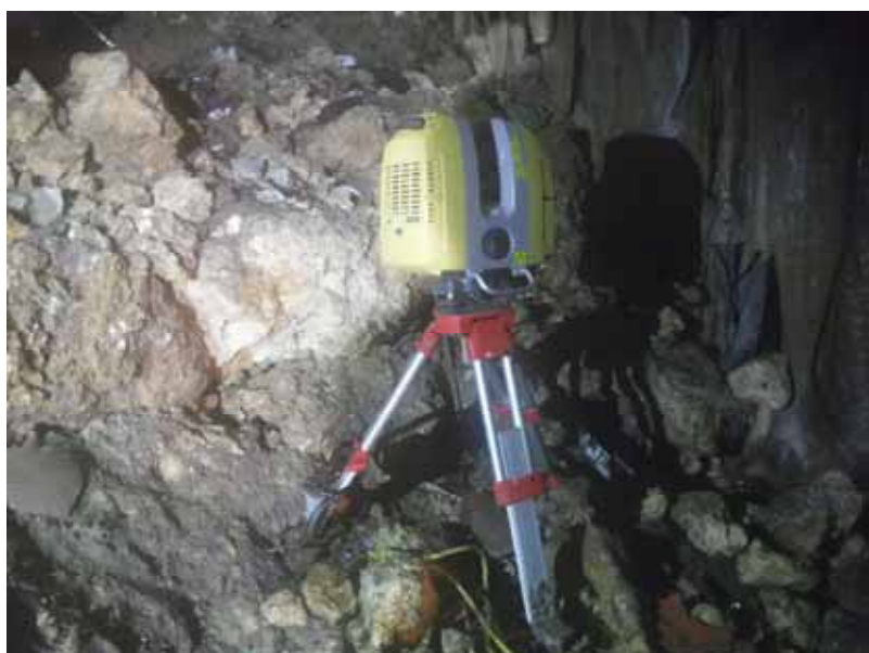
参考図 地上レーザー測量調査による坑道内部形状の測定（参考事例）
