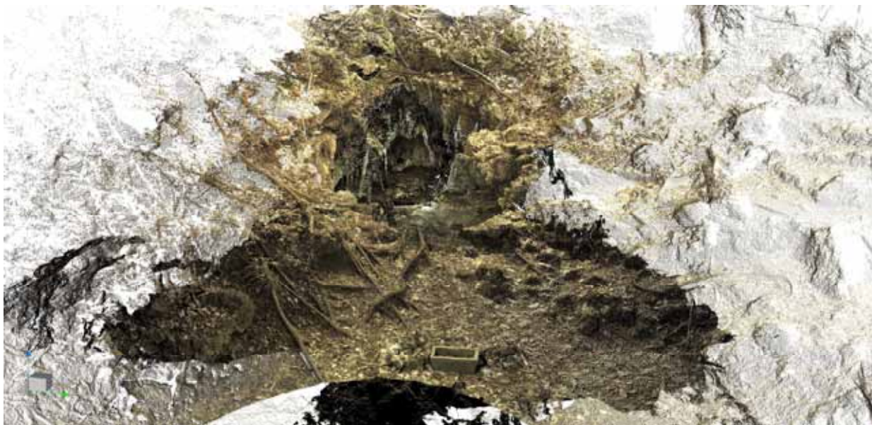
参考図 地上レーザー測量調査による坑道内部形状の測定（参考事例）
