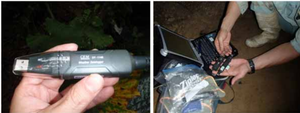
自動計測機器を用いた壕内部の温度・湿度の連続観測状況
