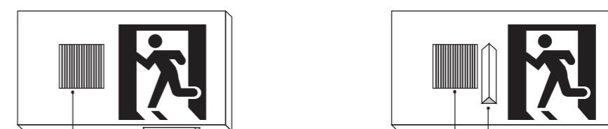
点滅ランプ 誘導音スピーカー 誘導音付加点滅形誘導灯
