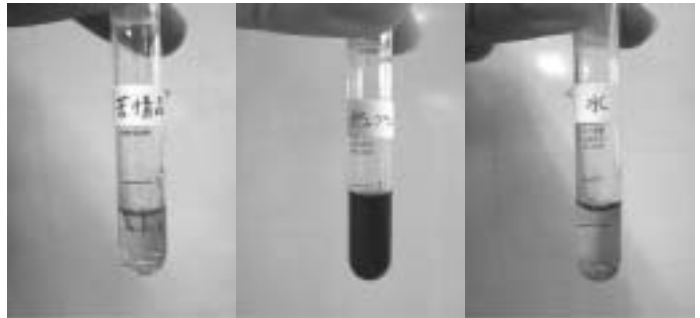
図6. ヨウ素デンプン反応結果. a:検体 b:デンプン水溶液 c:蒸留水
