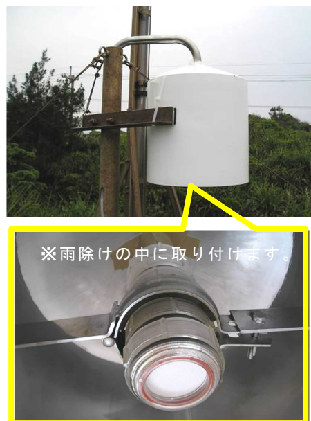
図 1. フィルターパック法の調査器具
