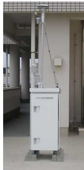
質量濃度自動測定機 FPM-377-1 型 (東亜 DKK(株)) 測定方式: β線吸収法
