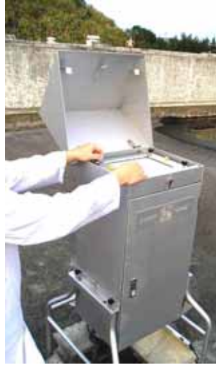
ハイボリュームエアサンプラの紙交換 ろ紙上に採取された大気浮遊粉じん試料(灰色部分)
