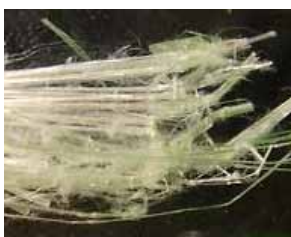
写真1. 6種類あるアスベストのうち代表的なクリソタイル(白石綿)
