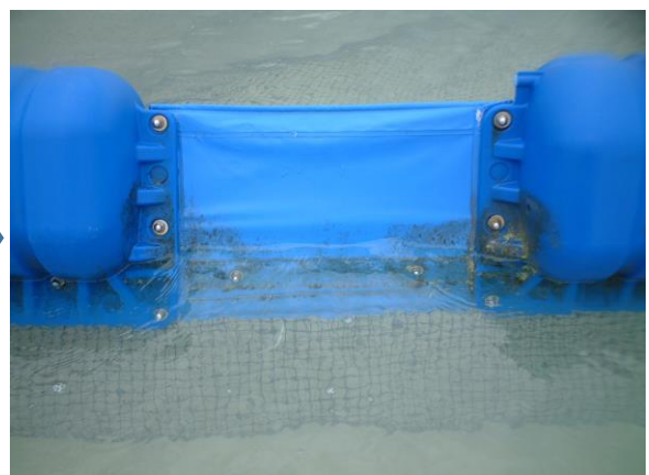
フロートとネットの間に隙間がない
