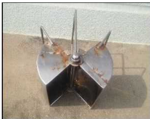
図 1 スミスマッキンタイヤ型採泥器
