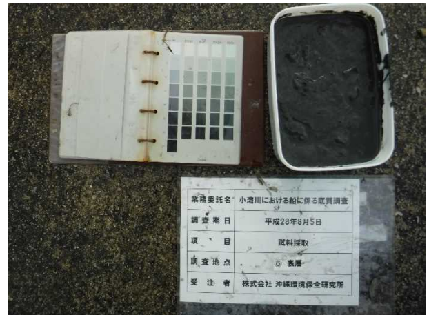
No-⑥ 採泥試料状況
