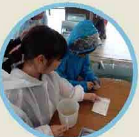
川の水と試薬を混ぜて、試薬の色の変化で水の汚れをチェックしました。
