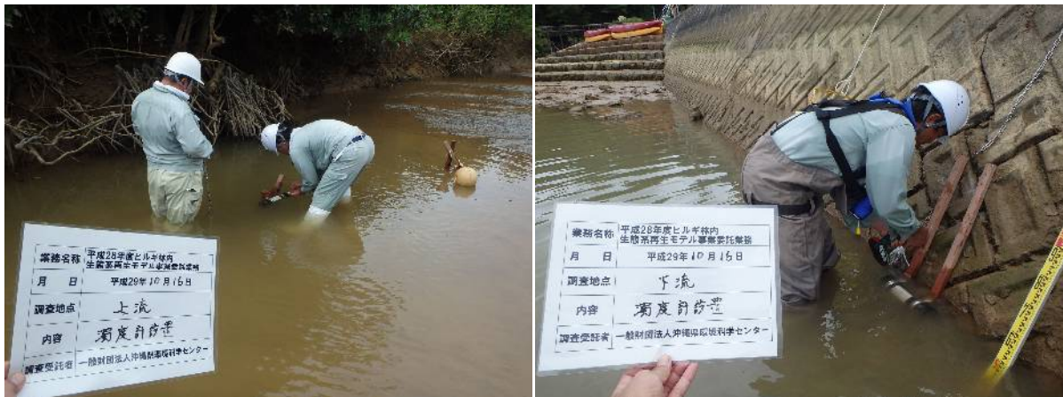
(濁度計の設置状況；工事区域上流側)
