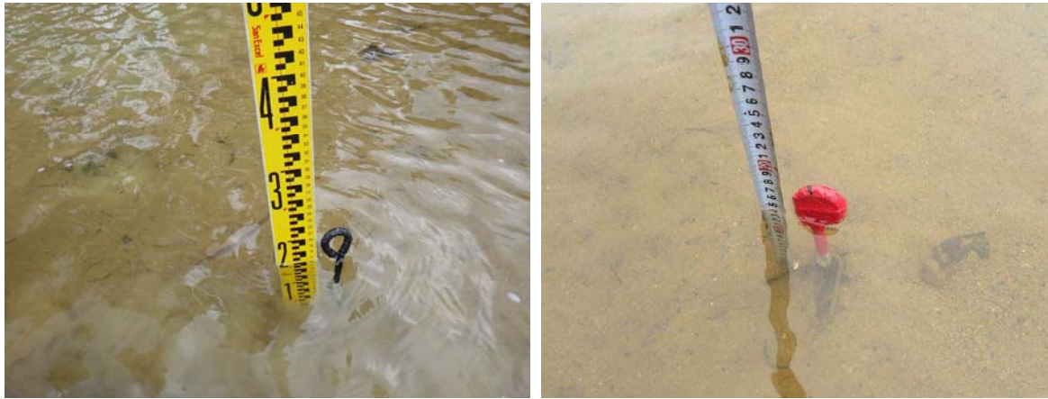
図 1. 3. 2-11 ワンド内に打ち込んだ鉄筋杭
