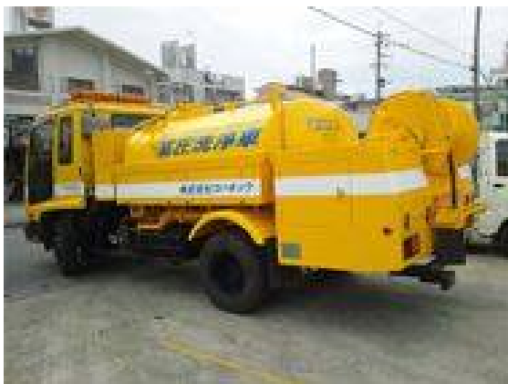
写真 1.1.3-3 高圧洗浄車 (ウォータージェットと接続)
