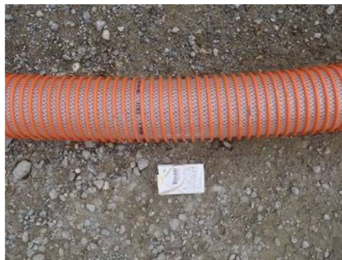
写真 1.1.3-2 バキュームホース：100mm 径 (土砂をバキュームまで吸引)
