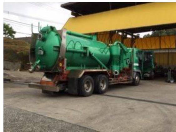
写真 1.1.3-4 吸引車 (バキュームホースと接続)
