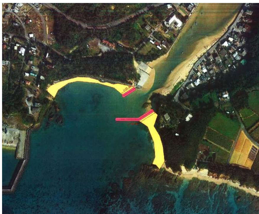
図 1.1.2-15 導流堤の整備イメージ図
