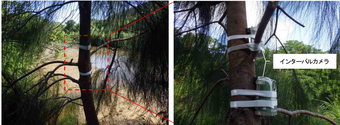
図 1.1.3.2-1 インターバルカメラの設置状況
