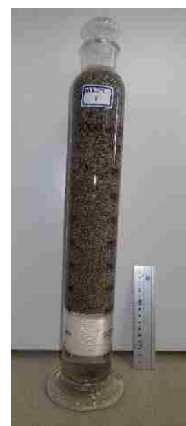
図①. 共栓付きメスシリンダーに粒状軽石を浸漬した様子
