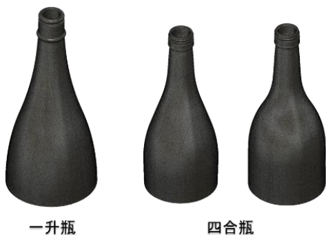
図1 X線CTスキャナにより取得した瓶の3Dデータ
