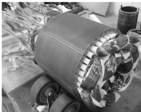
図15 巻線組み込み後のステータ
