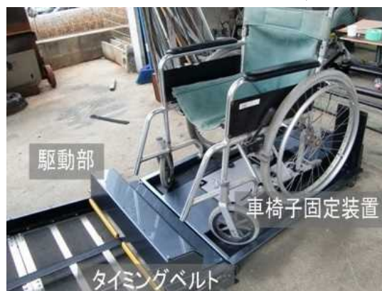
図 3.4 車椅子搭載状況
