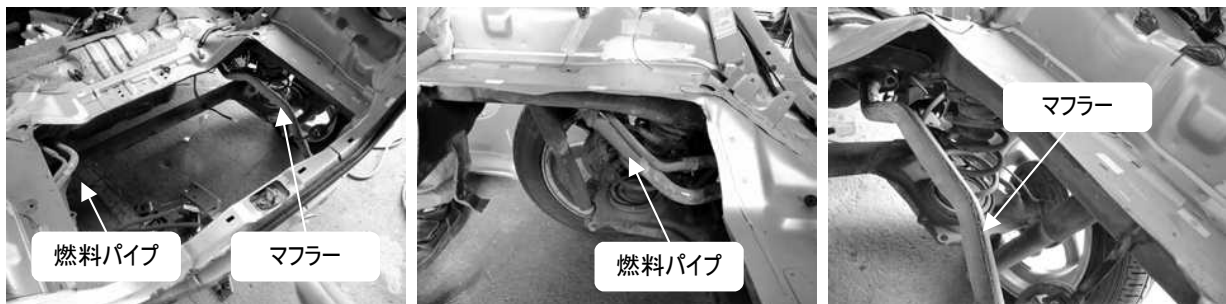
図 3.3 床部切断状況
