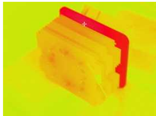
図25. 薄板フィンの温度分布（風当たり良好時）
