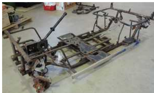
図 2. フレームの腐食
