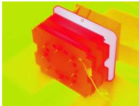
図 26. 薄板フィンの温度分布（無風時）
