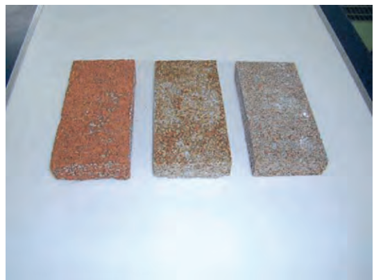
図8 試験体(1,040℃焼成)の外観
