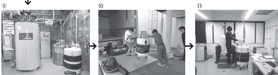
その後Heガスは液化機(左)で液化されLHe容器にためる
