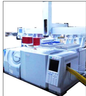
写真: ガスクロマトグラフ質量分析装置 (島津製作所製GCMS-QP2010Ultra)
